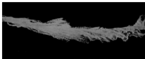
18 Fragment d'un arc électrique obtenu sous une tension d'environ 1 million de volts dans le laboratoire de la Metropolitan Vickers Electrical Company . (D'après l'illustration du 5 avril 1930).
